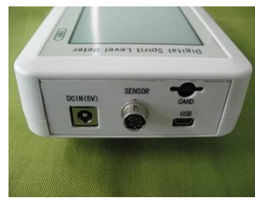
電源アダプタージャック、センサソケット及び外部 I/F
